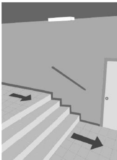
Рисунок 5.2 - Расположение светильника эвакуационного освещения на лестничном пролете
