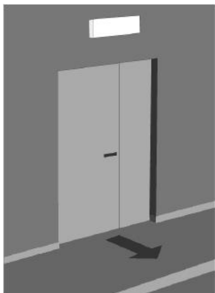
Рисунок 5.9 - Расположение светильника эвакуационного освещения снаружи здания
